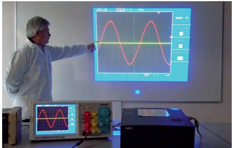
L'Iniscope avec sortie VGA (option disponible sur les modèles mono voie et double voie) vous permet de montrer l'écran de l'oscilloscope à l'ensemble de vos élèves à l'aide d'un vidéoprojecteur, et vous aide à leur expliquer l'utilisation d'un oscilloscope.
