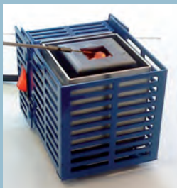
▲ Stérilisation d'une ose avec incandescence en quelques secondes.
