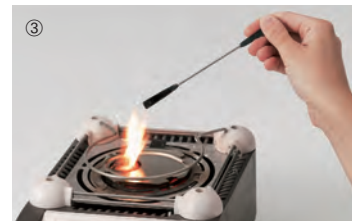
③ Combustion de poudre de zinc.
