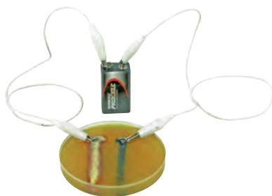
▲ Mise en évidence de la protection cathodique
