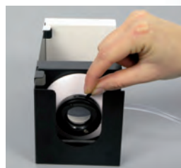
▲ Simulation du rôle de l'iris à l'aide du diaphragme réglable.
