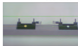
▲ Etape 3 : après collision, le chariot 1 s'arrête et le chariot 2 part à vitesse constante
