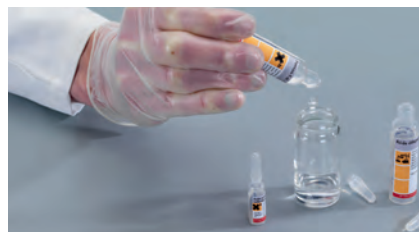
▲ Préparation du milieu réactionnel : mélange du contenu des 3 ampoules sécables.
