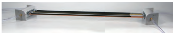
▲ Utilisation du kit avec une 2 ème enceinte (à commander séparément) afin de maintenir les 2 extrémités à température fixe.
