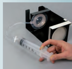
Ajustement de la focale de la lentille variable.
