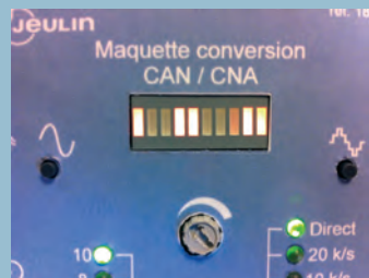
▲ Exemple de mot binaire pour une résolution de 10 bits : 1001100011
