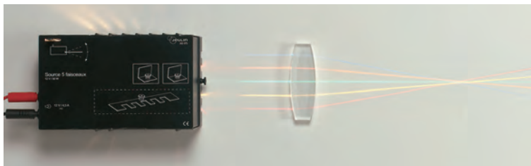
▲ Rayon lumineux à travers une lentille convexe.
