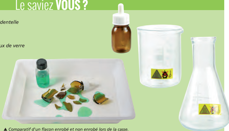
▲ Comparatif d'un flacon enrobé et non enrobé lors de la casse.
