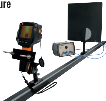
▲ Ensemble conductivité thermique (réf. 253 145) : étude de la conductivité thermique de 4 matériaux différents en régime permanent ou transitoire.
