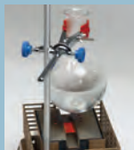
Chauffage d'un récipient sur la colonne d'air chaud, maintenu par la tige statif amovible, réf. 703 087.
