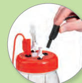
▲ Connexion rapide à une alimentation ou une pile pour un allumage par court-circuit
