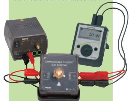
▲ Mesure de l'énergie consommée par une ampoule à l'aide du Joulemètre Initio® 2 réf. 292 087
